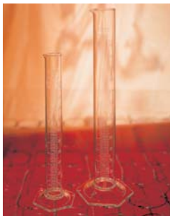
Messzylinder mit Sechskantfuß mit Strichteilung DIN 12 680, ISO 4788
